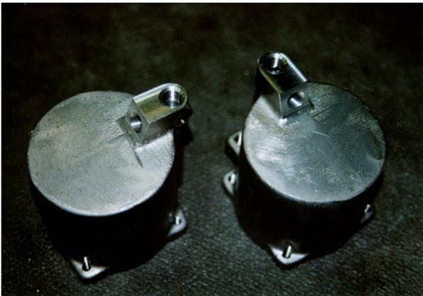
マシニングセンターA軸による多方向加工 /
