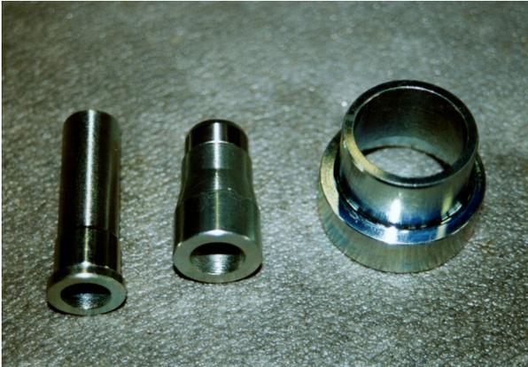
NC旋盤加工+メッキ+研磨加工 /
